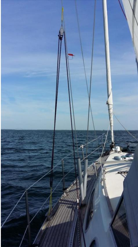
[Foto 6: geriggte Talje mit Block auf Genuaschiene]
