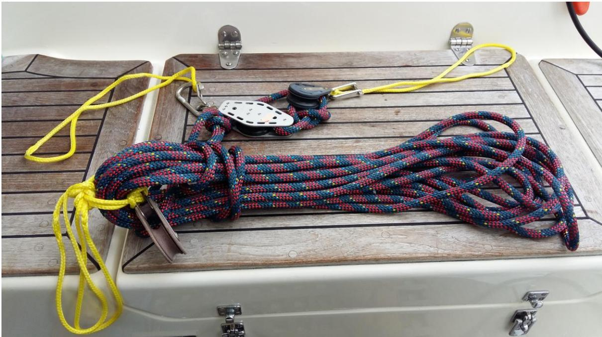
[Foto 5: Talje auf der Cockpitbank inkl. gelber Dyneemaschlaufen und zusätzlichem Fußblock zur Umlenkung des freien Endes]
